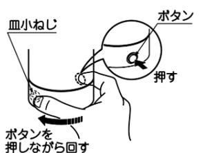
2. カバーリングの穴の位置を皿小ねじに合わせ、皿小ねじを外し、本体を抜く。
