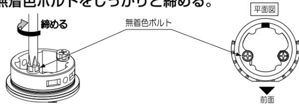
**ポイント** 各ボルトを交互に締め付け、締め付け力が均等になるように。
