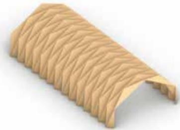
ハングアップ工法によって制作可能な折板架構のイメージ。複数のユニットを連結することも可能【提供：KAP】
