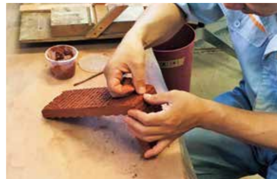
スクラッチタイル役物成形の様子。手作業で行われる
