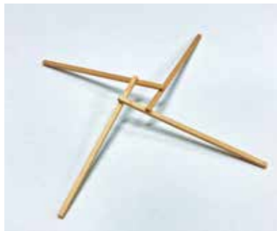
レシプロカル格子梁の接合方法。受材と組み合うよう上から落とし込んで接合する [提供: 山田憲明構造設計事務所]
