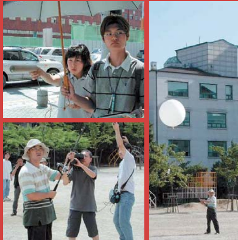
写真-12 筆者らのプロジェクトによる気象観測の様子（左上）気温・湿度の移動観測。（左下・右）釣りざおを改良した係留ソナデによる都市大気構造の鉛直観測。日本のTV局も取材に訪れた
