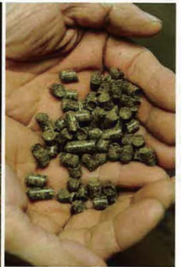
ペレットを持つ葛巻林業・楳木工場長。木皮(バーク)を粉砕したものを圧縮。加熱・圧縮工程で樹皮に含まれるリグニンという成分が溶け出し、天然の接着剤となって固形化するので環境にもやさしい。
