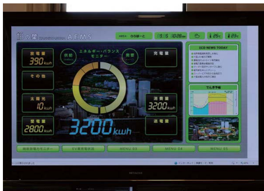
左上 / AEMS(Area Energy Management System)のモニター画面。柏の葉キャンパスのエネルギー状況がひと目でわかり、情報共有できる。AEMSは地域全体の発電量・受電量・消費電量を一元管理するシステム 上右・右 / NAS蓄電池、エリア全体のエネルギー管理・融通を想定した高効率・高性能の蓄電設備。ららぽーと柏の葉における夜間電力有効利用のほか、将来は災害時の非常用電源としても活用する予定
