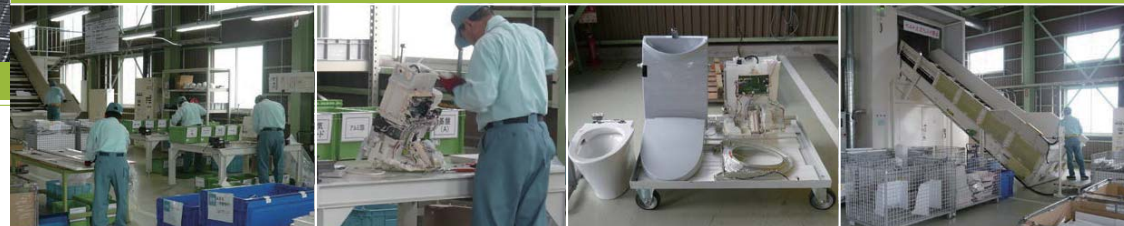
左・中左/エコセンターではリフォーム廃材を丁寧に手分解し、50品種以上に分別。商品知識のある現場職員によって、マテリアルリサイクル率90%以上を維持している 中右/分解されたシャワートイレ 右/施設内に破砕機、圧縮機を備え再資源化している
