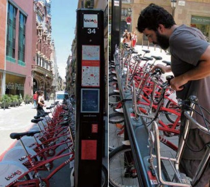
バルセロナで導入されているコミュニティサイクル「ビシング」。毎朝、整備された自転車専用配送車でステーションに配備する。自転車のフロントキャリアの下につけられた突起をラックの穴にはめ込んでロックする
