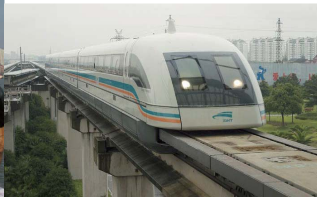
上海トランスピット（通称：上海マグレブ）は浦東国際空港駅と上海市郊外の竜陽路駅を結ぶ磁気浮上式鉄道。時速400kmを越すスピードが出るので、空港までわずか7分20秒で到達する。今後は杭州市まで延伸する計画がある
