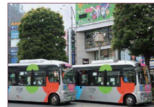
JR吉祥寺駅北口ロータリーで待機中のムーバス。狭い運行路に対応するため、全長約7m、幅約2mの小型バスを採用している
