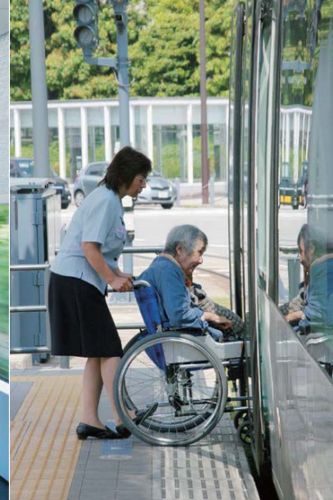
上左 / ポートラムの車内は、窓が大きく明るい。どの席からも景色を楽しむことができる 上右 / 低床車両で車いすでも乗り降りしやすいユニバーサルデザインになっている 下左 / ポートラムのカラーは全7色。シンボルマークは富山湾のブルーと富山のTから生まれた 下右 / 終点の岩瀬浜では、同じホームからフィーターバスへ乗り換えができる
