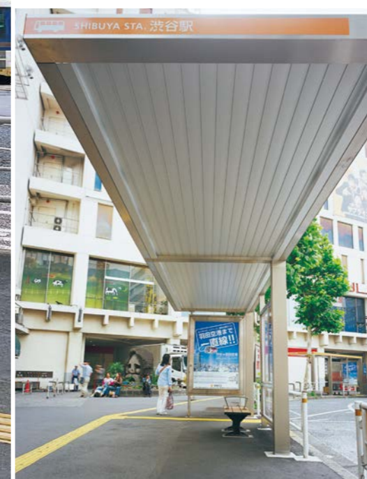
上／新しい4基のバス停は渋谷駅前のロータリー沿いに設置 下／屋根にはアルミを使用。LEDを桁の内側に隠し、新色の「ナチュラルシルバー」で美しい仕上がりに
