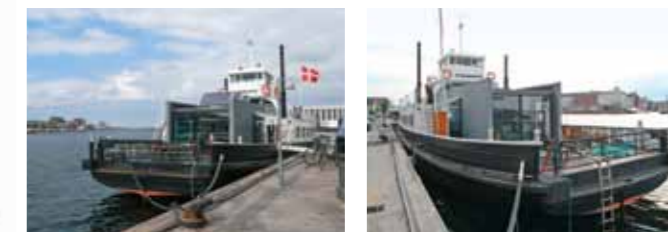
船首または船尾側から見ると、フェリーボートの広い甲板に2枚の壁が差し込まれている様子がはっきり分かる。フェリーボートは前後・左右対称形なので、どちらが船首でどちらが船尾かが分かりにくい。操舵室にあるハンドルの位置から推察すると写真右が船首側
