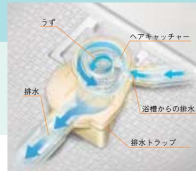
浴槽の残り湯によって排水トラップ内にうずを起すことで、排水口の掃除を簡単にし、ヌメリなどの発生も抑えます
