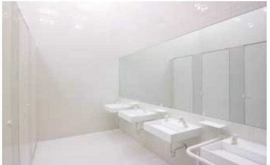
チケットトイレ（女子） 天井高を4000mmとし、高さのゆとりをとっている
